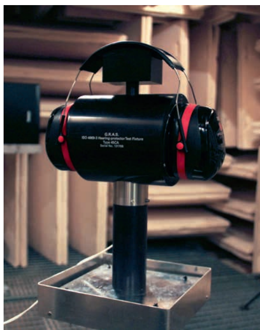
I ett ytterst välisolerat och tyst rum görs tester på de hörselkåpsmodeller som tas fram.
